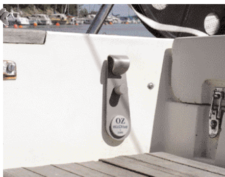
Rent elektromekaniskt är OZ:s reglage mycket robust. Det har tydliga klicklägen för stopp, propellerladdning och olika fartlägen framåt och bakåt.
