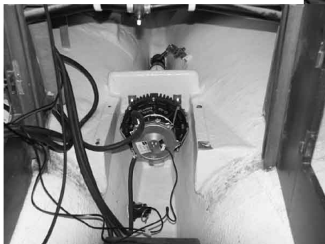
På ett skott monterat tvärs gamla motorfästet sitter motorn upphängd i en vagga
